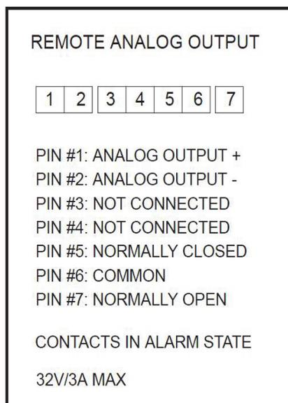
**Figure 2.** Configuration des broches de l'alarme à distance
